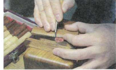
③荒彫り 黒い線を消さないように、朱の部分掘っていきます。とても繊細な作業です。
