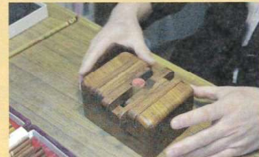
篆刻台 判子を固定するための台です。今はネジで固定するものが主流ですが、約30年使っているこちらがしっくりくるそうです。
