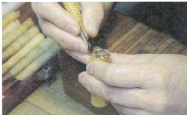
④仕上げ彫り 荒彫りしたものを仕上げていきます。もちろん彫る手も判子を持つ手も震えていません!!
