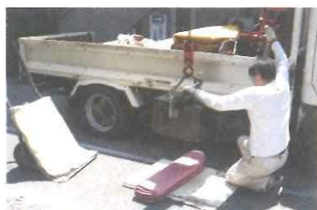
2. 出来上がった墓石をクレーンで下ろします。これで約120キロあるそうです。
