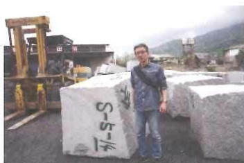
8. ある程度の大きさになったら丁場へ運びます。これで約3トンだそうです
