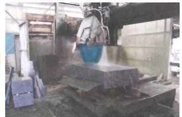
10. これは中サイズのカッターです。これで切り終わるのに1時間半かかります
